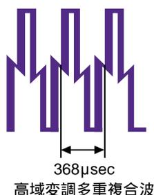
電気刺激は高域変調多重複合波を出力するテクニリンク社製の機器を用いて行った。高域変調多重複合波は完全な交流波形であり、基本周波数は筋肉収縮が起こりやすいとされる約2.7kHz (  $1 / 368\mu\text{sec}$  )である。高い周波数から低い周波数までの合成波とするためにデューティ比50%のPWM( Pulse Width Modulation )波形となっている。
